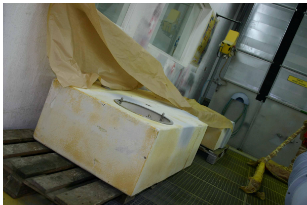
Flotteur en mousse syntactique comportant des fissures à colmater avec du mastic
