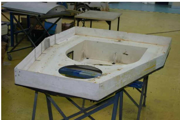
Partie en fibre de verre à réparer avec de la résine
