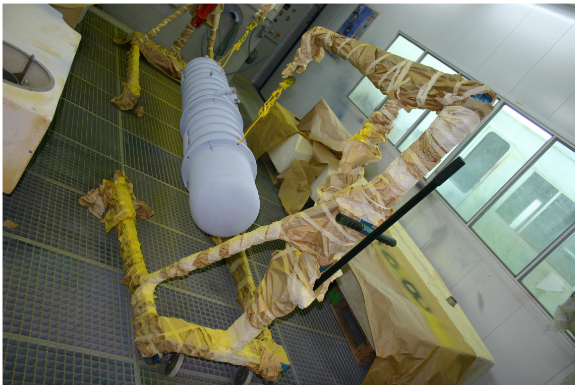
Un cylindre, maintenu à l'aide de deux "chèvres", a été recouvert d'apprêt
